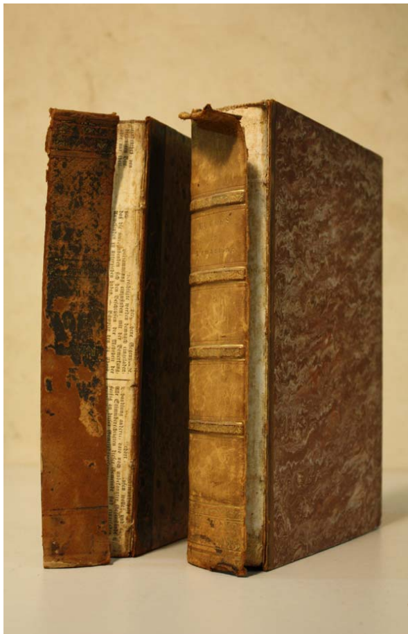
Zwei Halbledereinbände mit gebrochenen Lederrücken. Das Leder des linken Bandes ist stark abgebaut.
