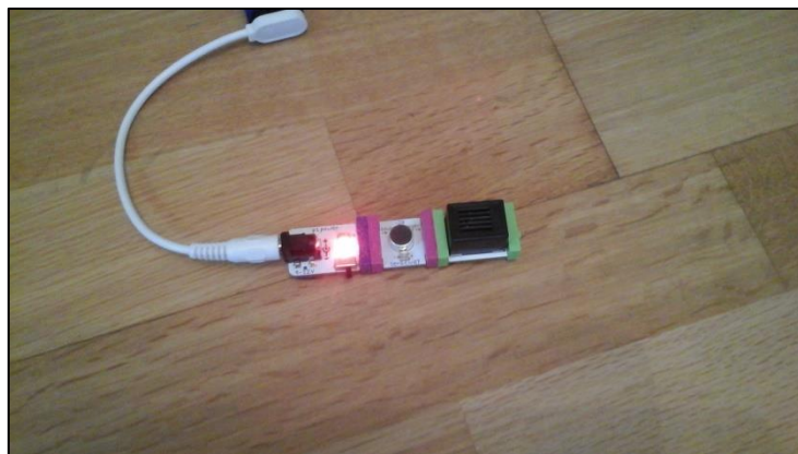
Abbildung 31: Anwendung 3.1: Soundtrigger-Bit in Kombination mit dem Buzzer-Bit
