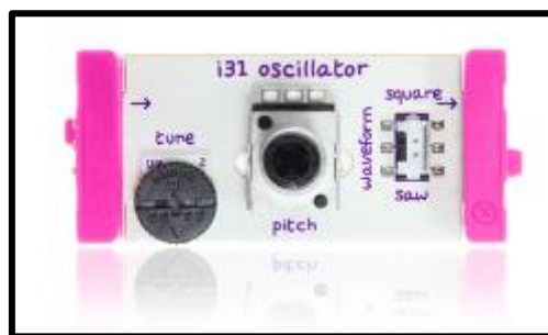
Abbildung 25: Einzelnes littleBits Input-Modul namens "Oscillator", geeignet um Sounds zu erzeugen (littleBits Electronic, 2016a).
