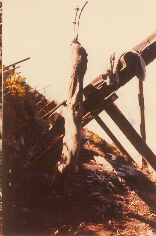
Bild 2: Injectobohr-Anker des Versuchs 1 nach dem Herausziehen. Es gibt keinen Verbund zwischen dem glatten Sack und dem umliegenden Boden.
