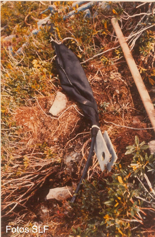
Bild 1: Anker der Firma Injectobohr mit Hüllsack, Schlauch zum Verpressen der Zementmilch und Ankerstab.
