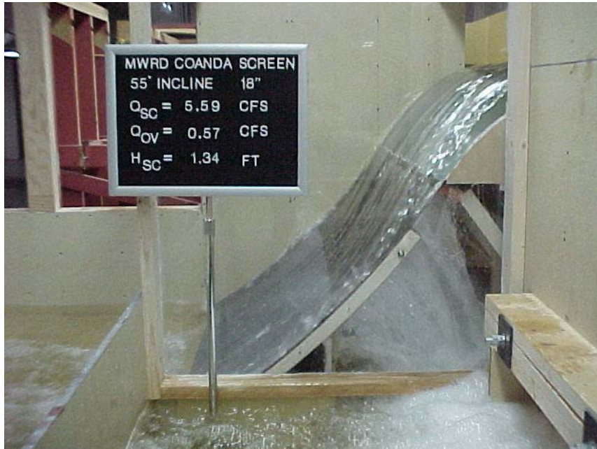
Abbildung 17: Modellversuch am Coanda-Rechen im Bureau of Reclamation, Denver, Colorado (USA) (Wahl, 2003)
