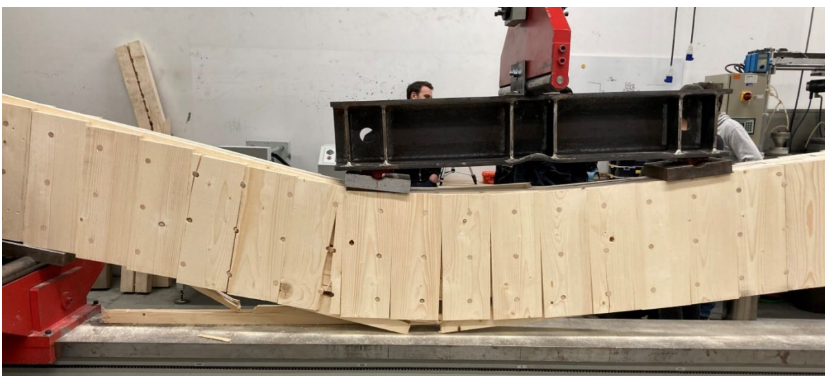
Abbildung 46: Holzbalken Versuch auf dem grossen Prüfportal des Baulabors.
