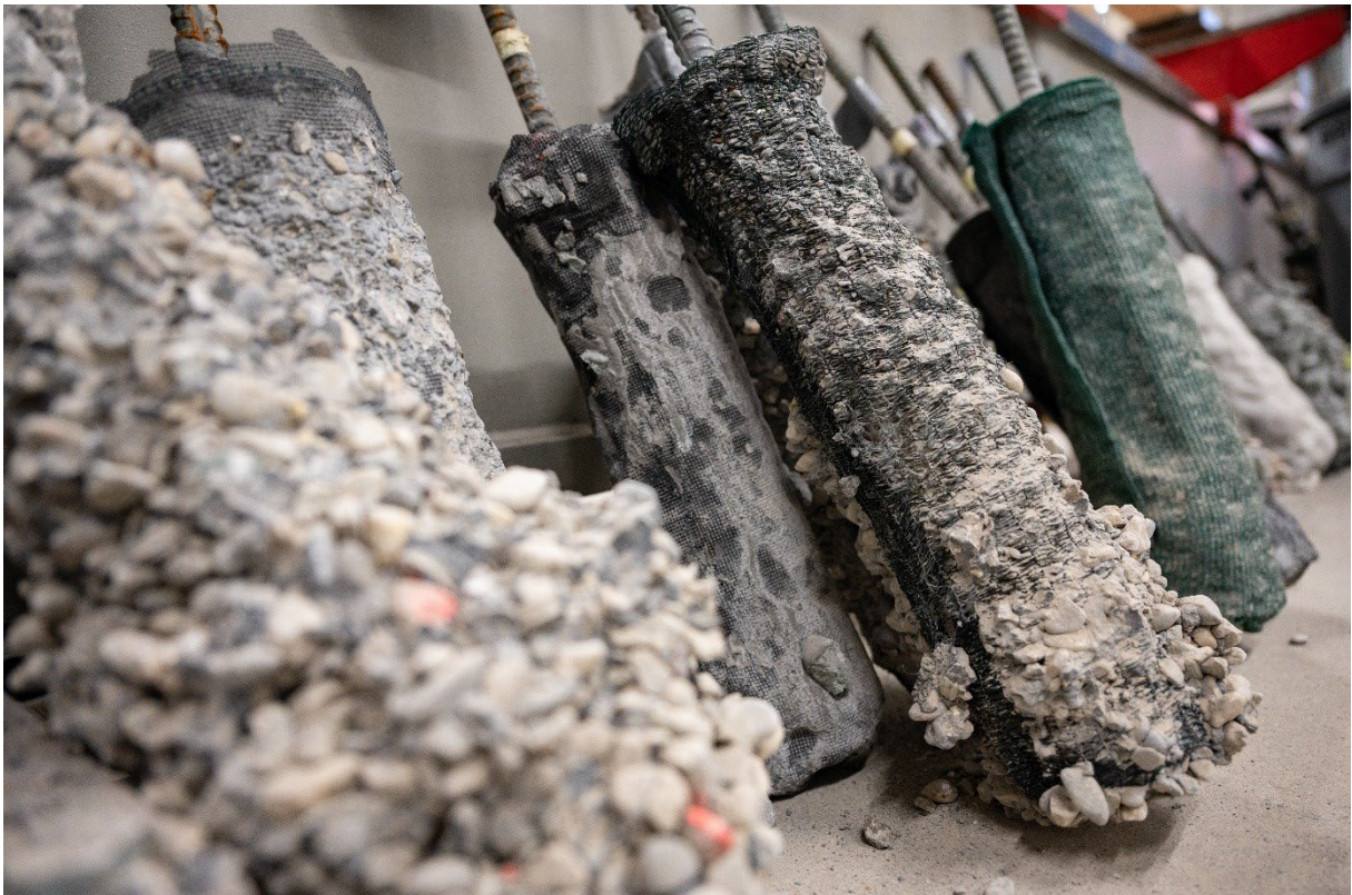
Abbildung 1: Zuganker mit Geotextilsäcken
