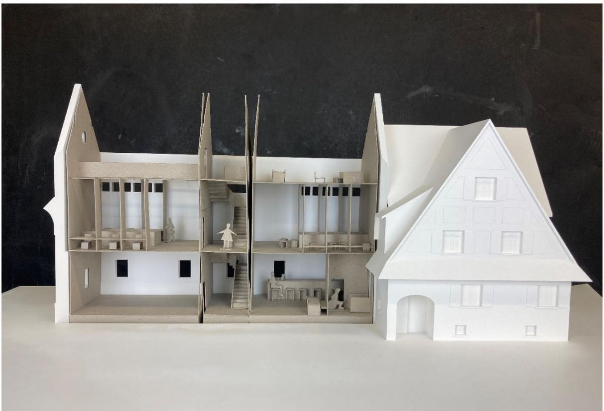
Abbildung 30: Linus Pfister – Eine neue Treppe in der Schaltstation ermöglicht die Neunutzung der Räume als Innovationsbereiche für ehemalige Studierende der FH Graubünden und Start-Ups.
