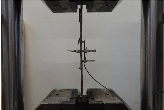
Abbildung 47: Baustahluntersuchung mit Universalmaschine gemäss SN EN 6892-1
