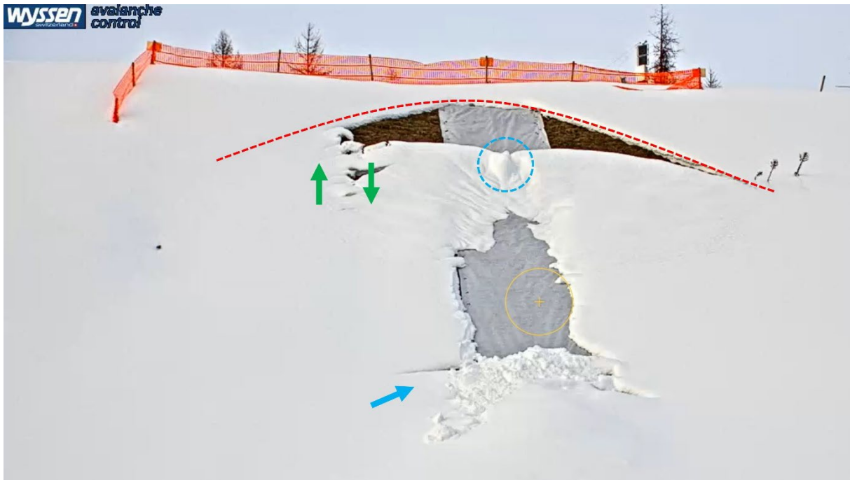
Abbildung 3: Schneensammlungen auf den Geotextilbahnen rutschen in kleinen Mengen ab.
