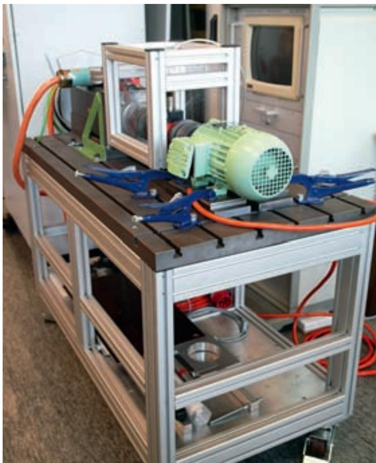
*Auf dem Prüfstand: Die Messung zeigt, wie viel Energie der Kleinmotor in Antriebsenergie umwandelt und wie viel verloren geht.*
