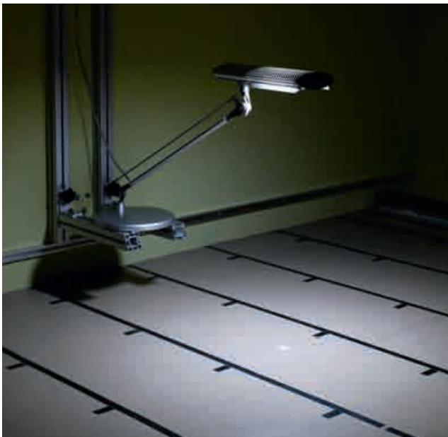
Eine Büroleuchte wird im Leuchtenlabor auf ihre Beleuchtungsqualität und Energieeffizienz getestet.
